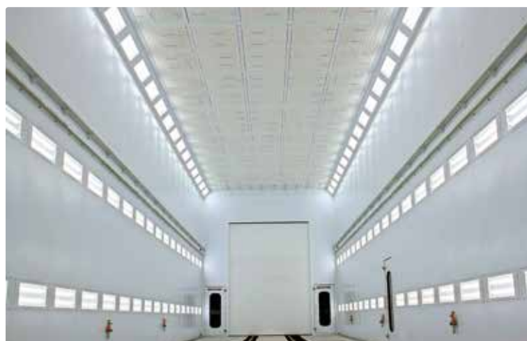
■ Przykład kabiny lakierniczej dla pojazdów użytkowych
