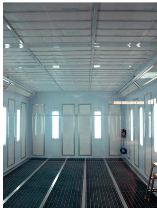
Przykład kabiny lakierniczej z systemem ekranów promiennikowych
