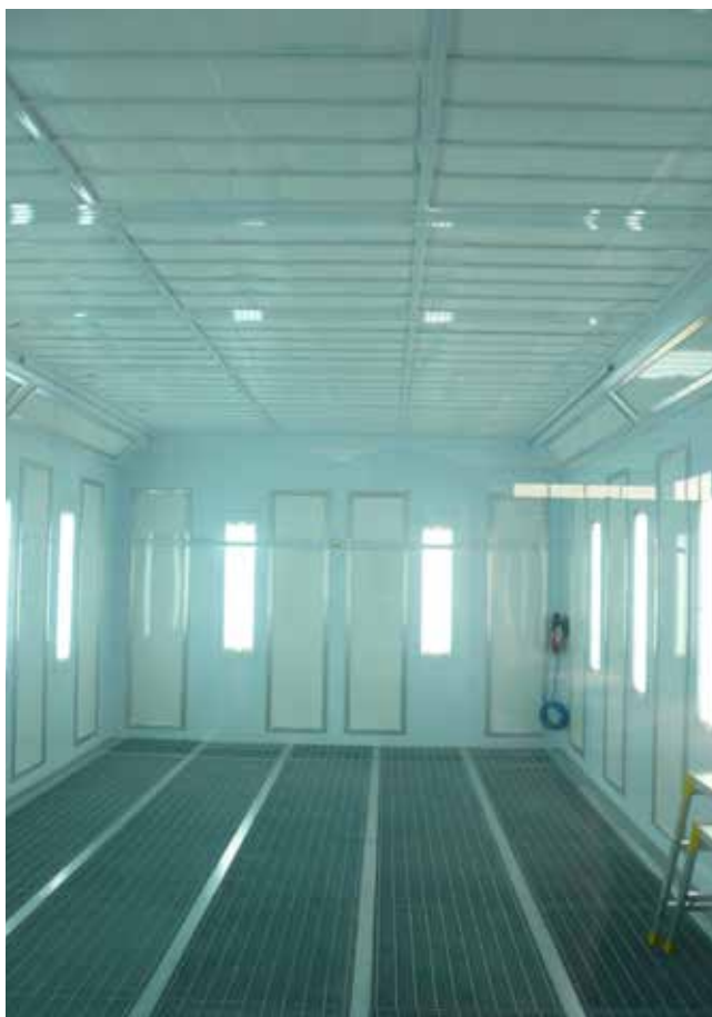
■ Przykład kabiny lakierniczej z systemem ekranów promiennikowych
